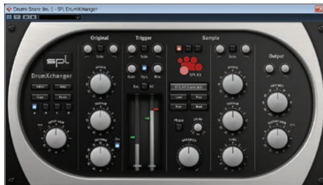
Mit dem DrumXchanger präsentiert SPL ein Werkzeug zum Ersetzen von Schlagzeugklängen, dessen Klangerkennung pegelunabhängig arbeitet.
