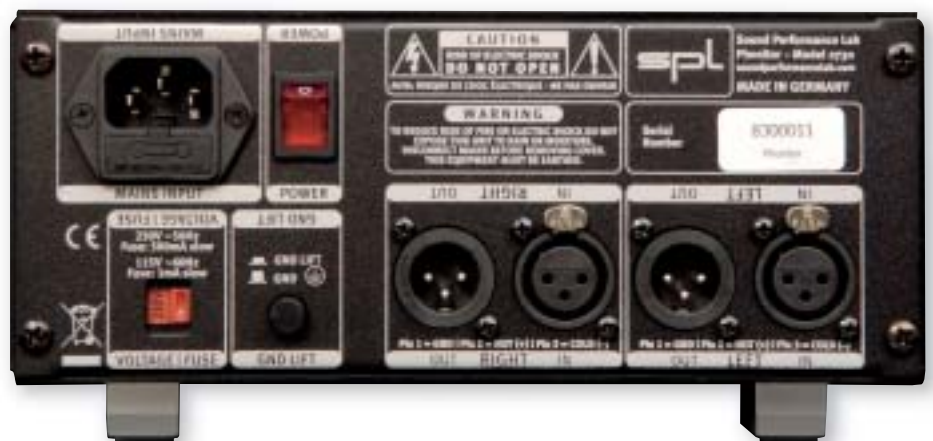
Der Phonitor verfügt über symmetrische Ein- und Ausgänge. Sinn und Zweck: Die eingespeisten Signale werden unverändert durchgeschleift, so dass bei Einsatz des Kopfhörer-Verstärkers kein zusätzlicher Monitor-Kanal geoptert werden muss.
