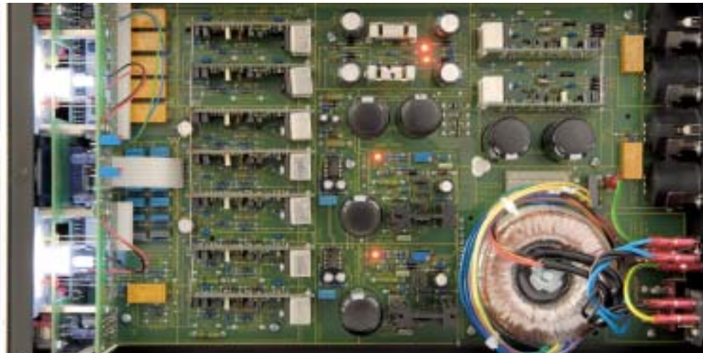
Der Phonitor ist mit der von SPL entwickelten 120-Volt-Technik gebaut, die in der Highend-Mastering-Serie des Herstellers zum Einsatz kommt. Eigens entwickelte sogenannte Supra-Operationsverstärker mit 120 Volt Betriebsspannung garantieren für exzellenten Klang. Im Phonitor kommen neun dieser Verstärker-Bausteine zum Einsatz.
