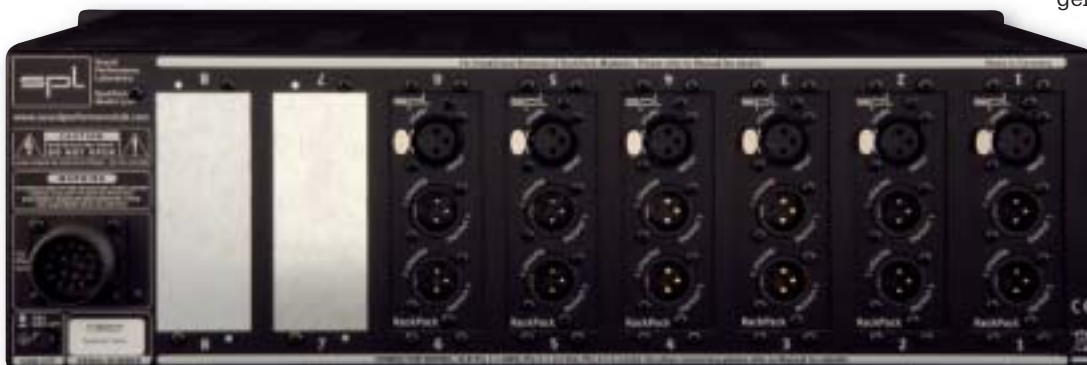
Der 17-polige Anschluss verbindet das Muttergerät mit dem externen Netzteil. Ein Ground-Lift-Schalter eliminiert auftretende Brummschleifen.
