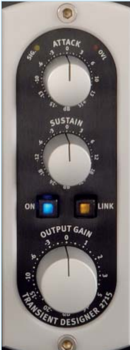
Neu am Transient Designer-Modul ist der Ausgangspegel-Regler. Attack und Sustain bestimmen Einschwing- und Ausschwingverhalten des bearbeiteten Signals.
