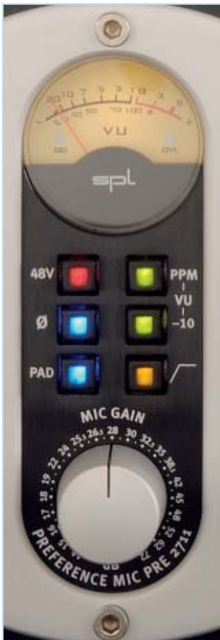
Das multifunktionale VU-Meter der MicPres eignet sich zur Kontrolle von Durchschnitts- und Spitzenpegeln, lässt sich in seiner Anzeigenempfindlichkeit verändern und ist außerdem mit zwei LEDs (Peak, Signal) zum komfortablen Einpegeln ausgestattet.
