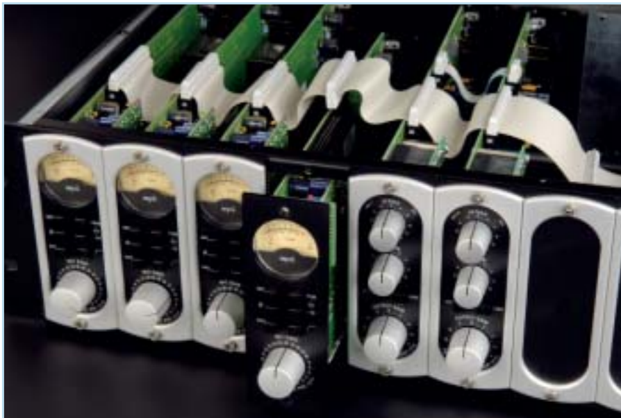
Anders als die Black Series von Audient verfügt das RackPack über völlig autarke Module mit eigenen Anschlussbuchsen, die fest an der Platine verlötet sind.
