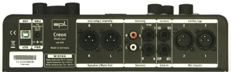
Das Anschlussfeld des Creon: stereo rein (Mic/Line), stereo raus (Speaker), dazu zwei AUX-Eingangspaare (Klinke/Cinch)
