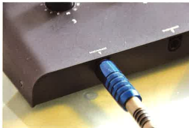
Die beiden Instrumenteneingänge sind an der Vorderseite untergebracht, sodass E-Gitarre oder -Bass sich komfortabel verbinden lassen
